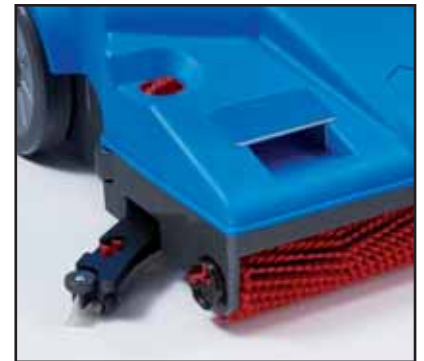
Zakřivená stírací lišta přímo za válcovým kartáčem
